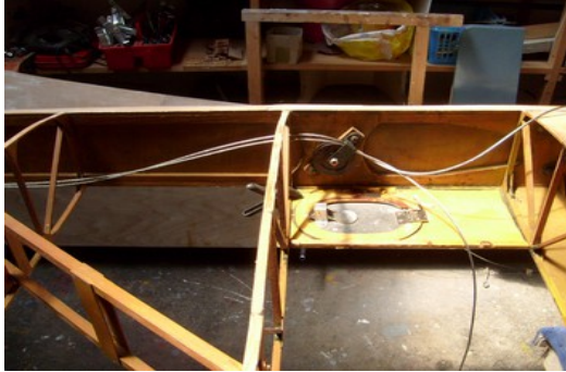
Beschläge und Seilrollen gereinigt
