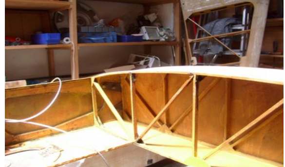
Die Rippe 0 u. 1 neu aufgebaut
