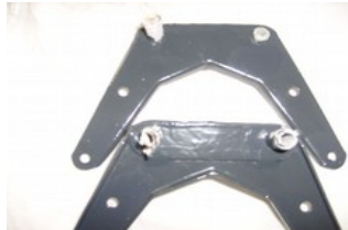
Beschläge gereinigt u. lackiert
