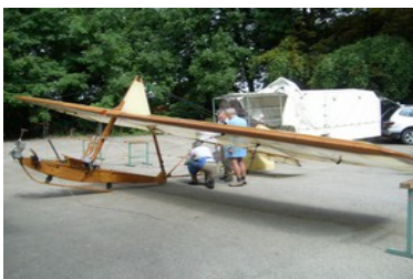
SG 38 Montage f.d. Abnahme
