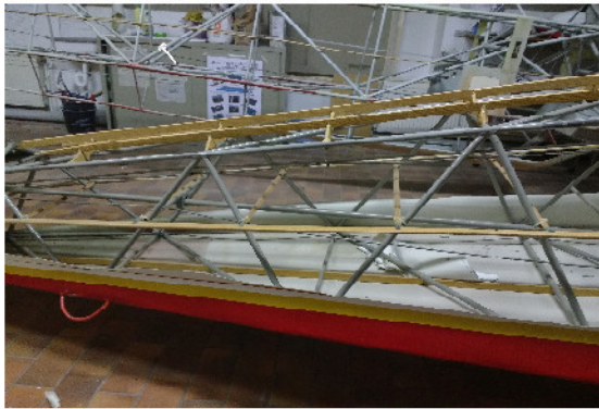
Bespannung entfernt und das Rumpfgerüst auf Beschädigungen überprüft.
