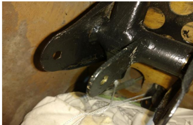
Querruderbeschlag gereinigt und lackiert
