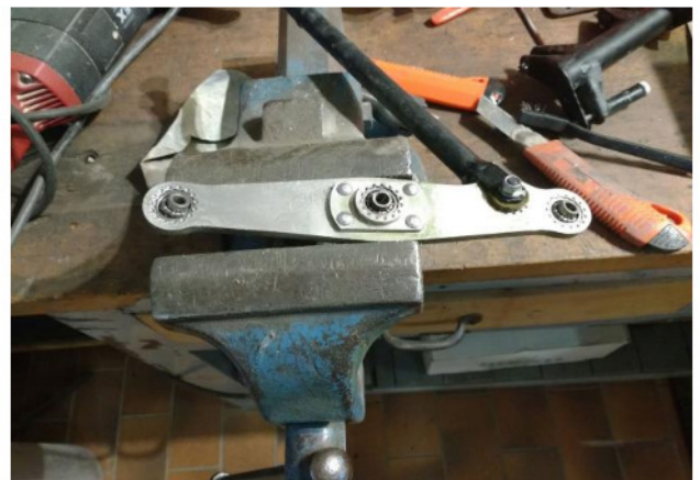
Alubeschläge gereinigt und lackiert
