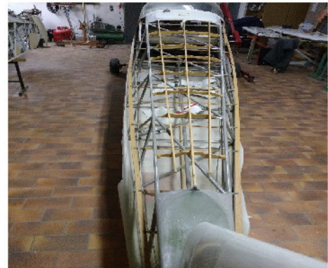
Steuergestänge und Sporn ausgebaut Gereinigt, überprüft und gefettet
