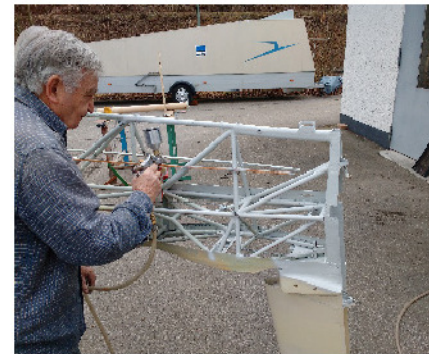
Das Rumpferüst gereinigt und lackiert
