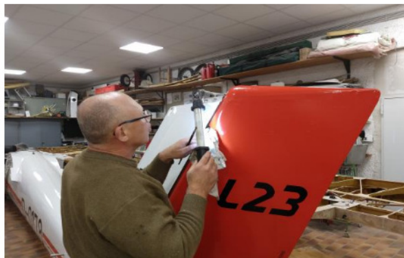
Seitenruderlagerung überprüft und geölt oder gefettet
