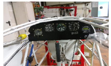
Instrumentenbretter erneuert und die Instrumente überholt
