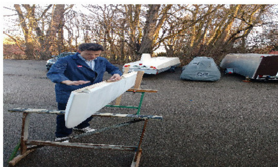
Höhenruder-Dämpfungsfläche gereinigt und alten Lack entfernt
